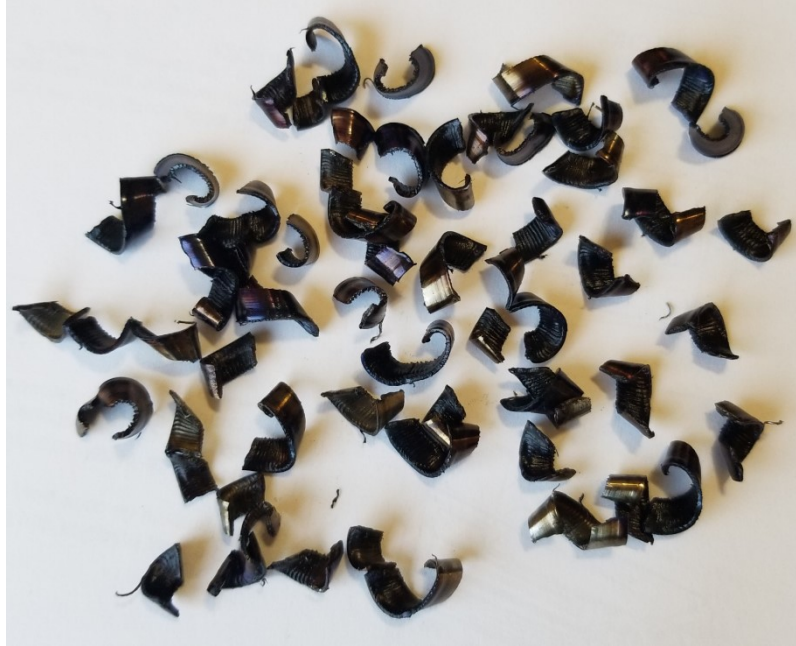
Figura 43 - Geometria final do cavaco gerado no segundo experimento (pastilha CNMG 190612 RP da classe KC5010, produzido pela Kennametal).
