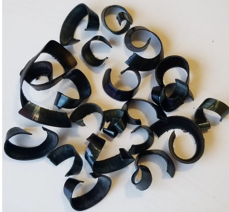
Figura 44 - Geometria final do cavaco gerado no terceiro experimento (pastilha WNMG 080412 RP da classe KCU25, produzido pela Kennametal).
