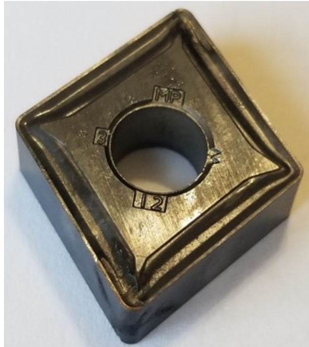
Figura 31 - Inseto da Kennametal, modelo CNMG 190612 MP da classe KC5010 após a usinagem.
