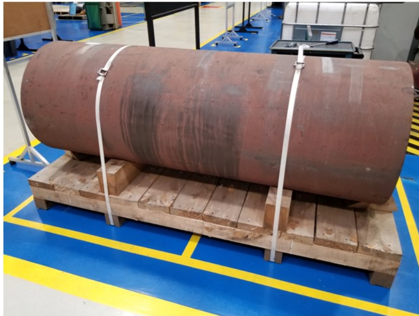
Figura 20 - Matéria prima forjada.
