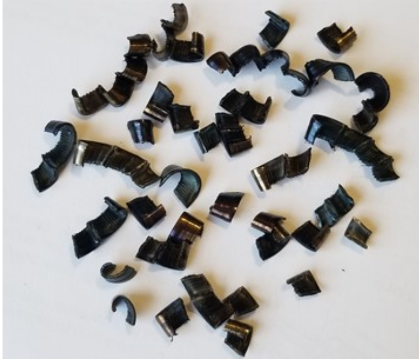
Figura 42 - Geometria final do cavaco gerado no primeiro experimento (Pastilha CNMG 190612 RP da classe KCU25, produzido pela Kennametal).
